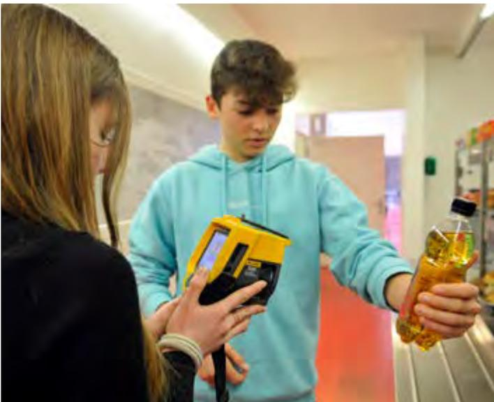
Messung mit der Wärmebildkamera
