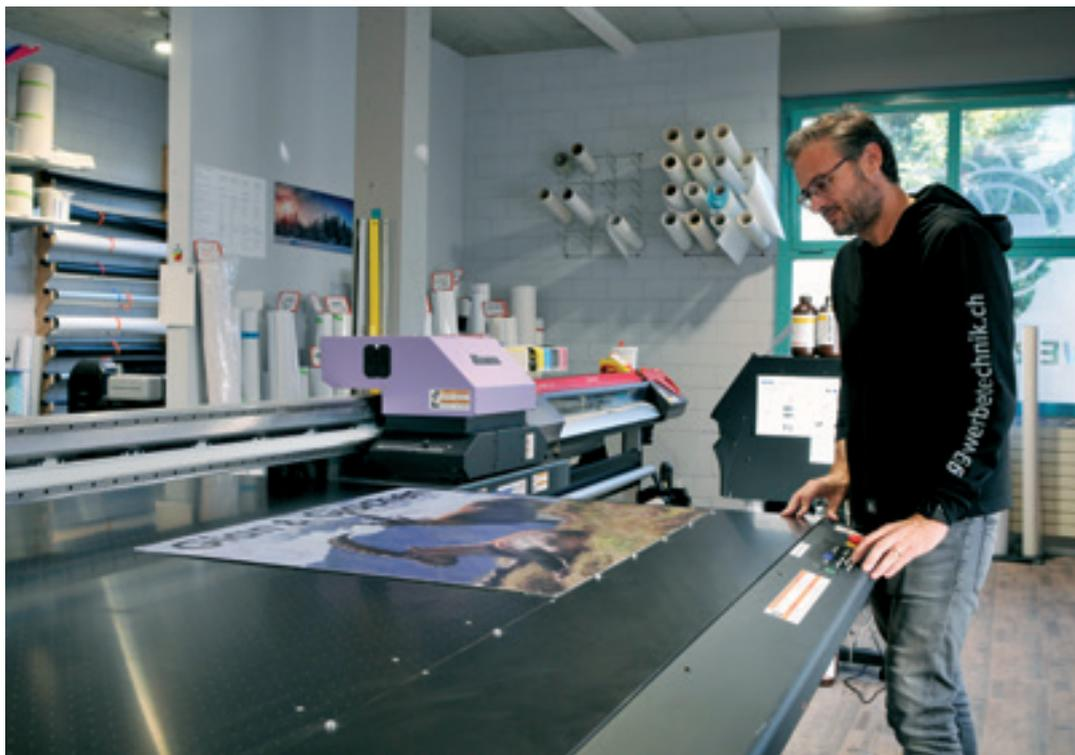
**Vielseitig:** Der neue Flachbettdrucker bedruckt Materialien wie Aluminium, Holz, Glas und Stein bis zu einer Dicke von 5 Zentimetern.
